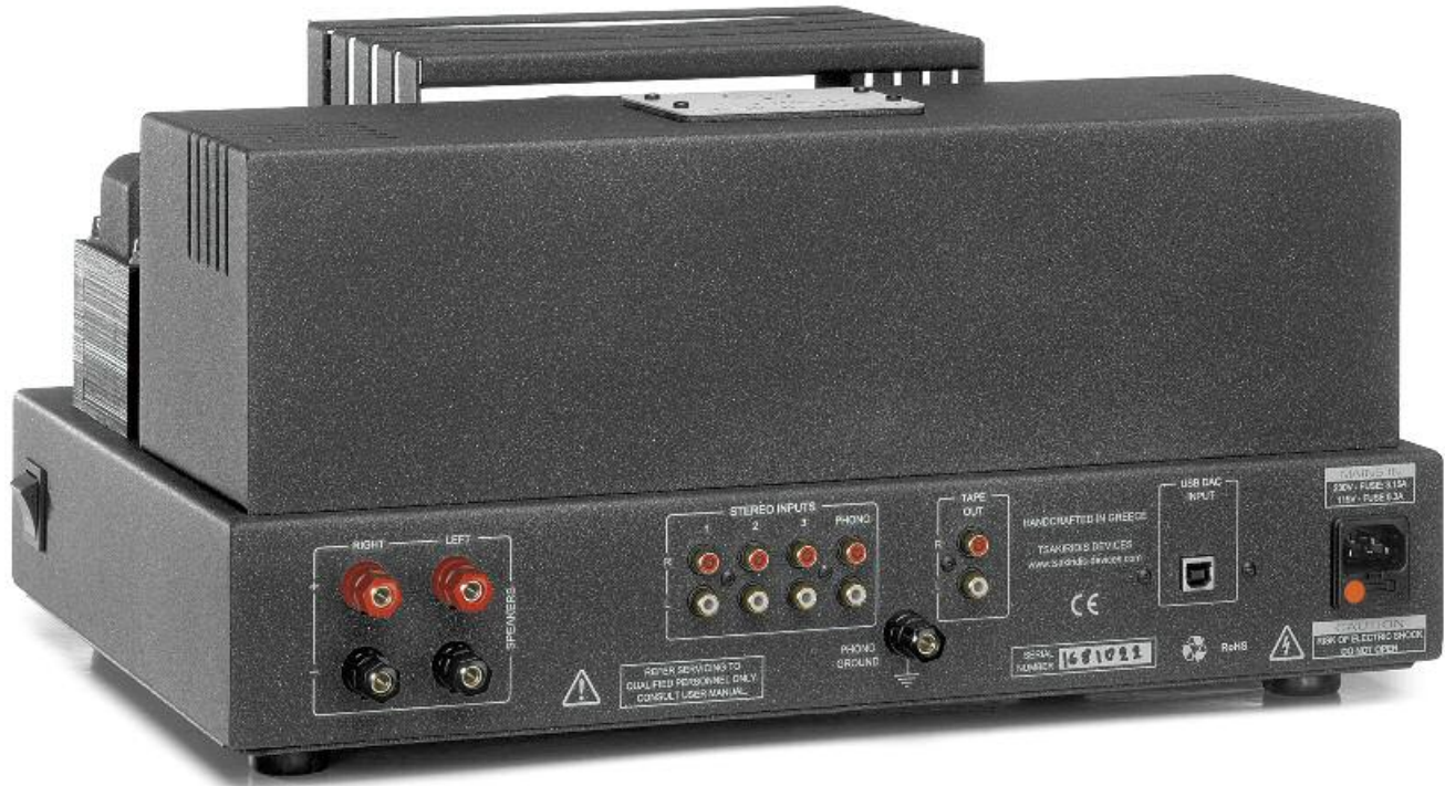
Die Heckseite des Theseus: Es gibt nur einen Abgriff für Lautsprecher, dafür einen Phonoeingang und drei Hochpegelanschlüsse sowie einen USB-Digitaleingang
