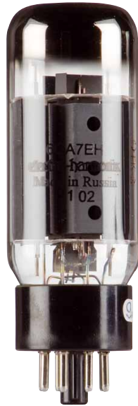
Die Endröhre links ist eine nahe Verwandte der EL34, die beiden Doppeltrioden rechts verstärken in der Vorstufe
