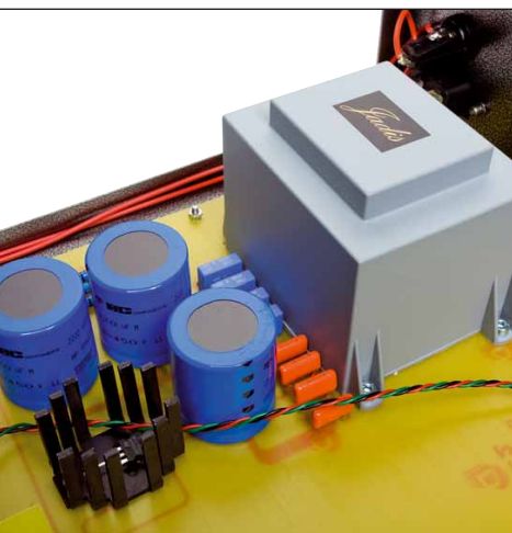
Das Netzteil heizt die Röhren mit Gleichspannung; der Regler stabilisiert die Spannung
